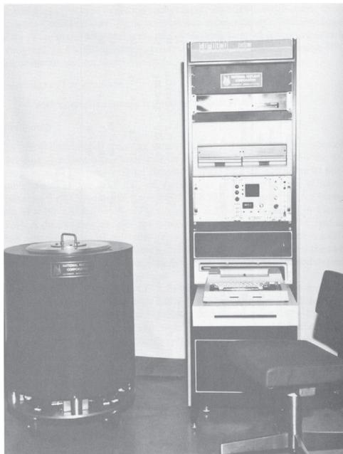
*Рис. 5.23. Колодезный счетчик нейтронных совпадений NWCC (фотография любезно предоставлена Национальной ядерной корпорацией)*
